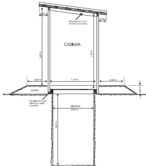
**Fig. 2 - LAJE DE CONCRETO PARA PISO DE PRIVADA**
